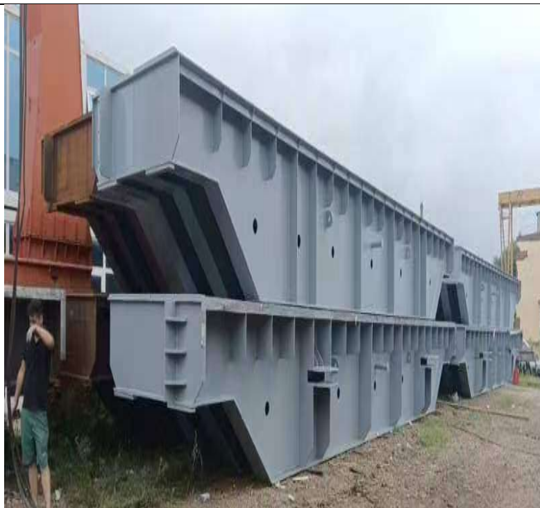
फोटो दः निर्माणस्थलमा हाईड्रोमेकानिकल उपकरणहरु Stoplog and Penstock pipes
