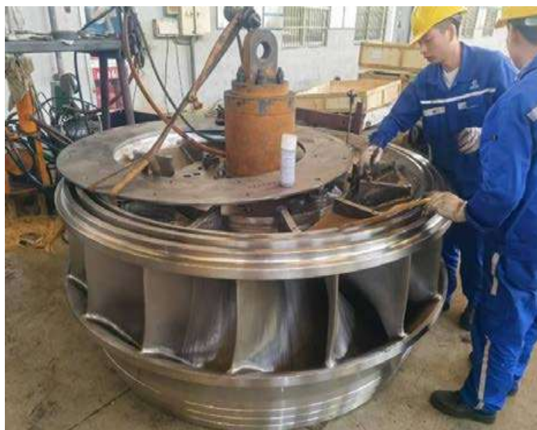
फोटोहरु ९: इलेक्ट्रोमेकानिकल निर्माण कार्य अन्तर्गत आयोजनाको प्रस्तावित Turbine Runner कार्य, Hanzhou, China
