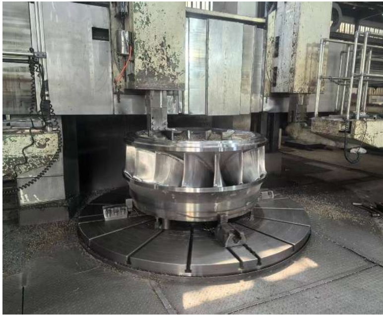
इलेक्ट्रो मेकानिकल निर्माण कार्य अन्तर्गत आयोजनाको प्रस्तावित Turbine Runner कार्य, Hanzhou, China
