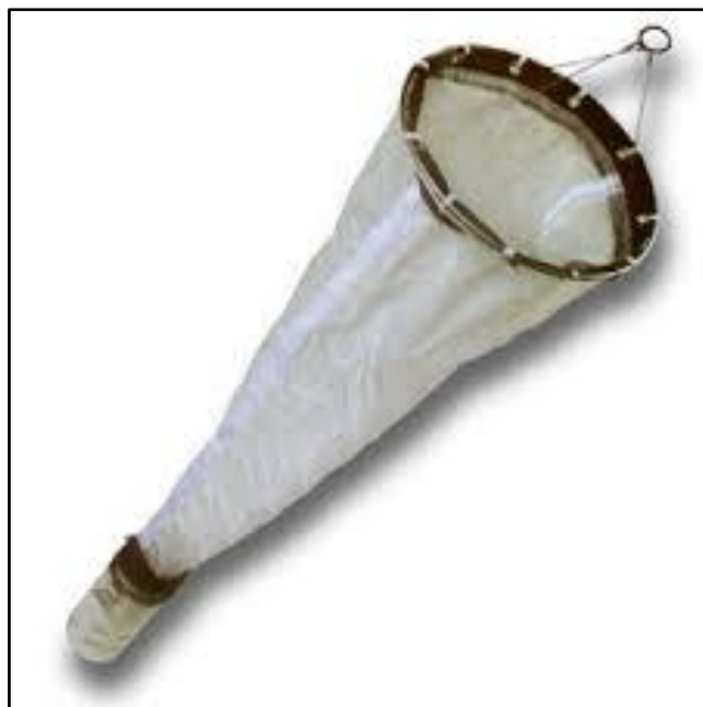
प्लेट ३-५: Phytoplankton को अध्ययनमा प्रयोग भएको plankton net
