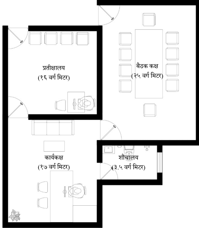
चित्र १५: उपसचिव (रा.प. द्वितीय श्रेणी) वा अधिकृत (रा.प. तृतीय) श्रेणी को आयोजना प्रमुख/ कार्यालय प्रमुखको कार्यकक्षको नमूना नक्सा
